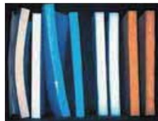
**グラスウールなら** 高温多湿な状態に長時間置かれても、変形や劣化が無く新築時と変わらない断熱性を保ちます。
