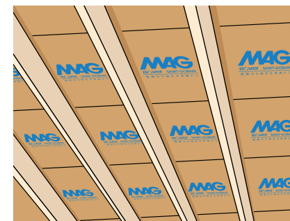
①通気層確保部材設置
