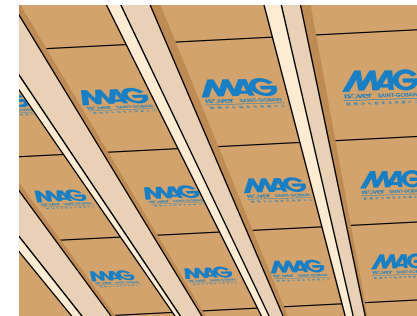
①通気層確保部材設置
