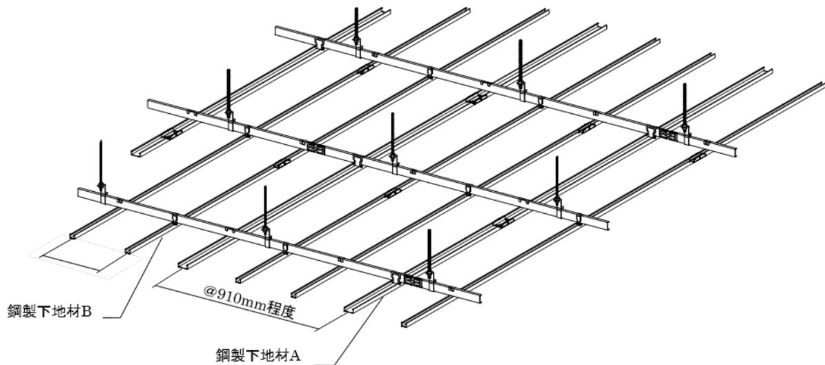
図 1-3-1 鋼製下地材の施工(例図)
