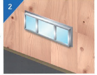
サッシをはめ込み、固定します。
