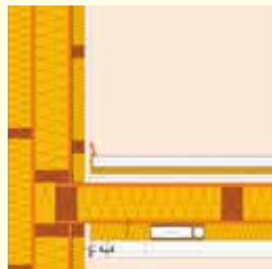
壁断熱強化 U値:0.1W/m 2 K
